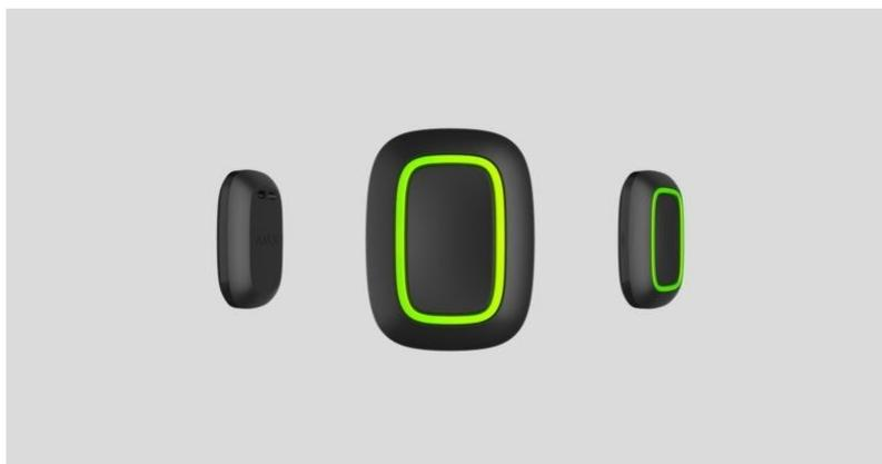
**Button** est un bouton de panique sans fil avec protection contre un appui accidentel et mode de contrôle supplémentaire pour les appareils d'automatisation.
