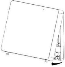
Retirez le couvercle avant de la centrale en le faisant basculer vers l'extérieur.
