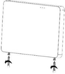
Utilisez un tournevis cruciforme pour dévisser les 2 vis de fixation situées au bas du panneau.
